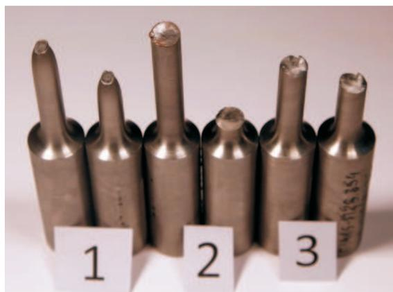
Рис. 4. Сплошные цилиндрические образцы после испытаний растяжением (1), кручением (2) и растяжением-кручением (3)
