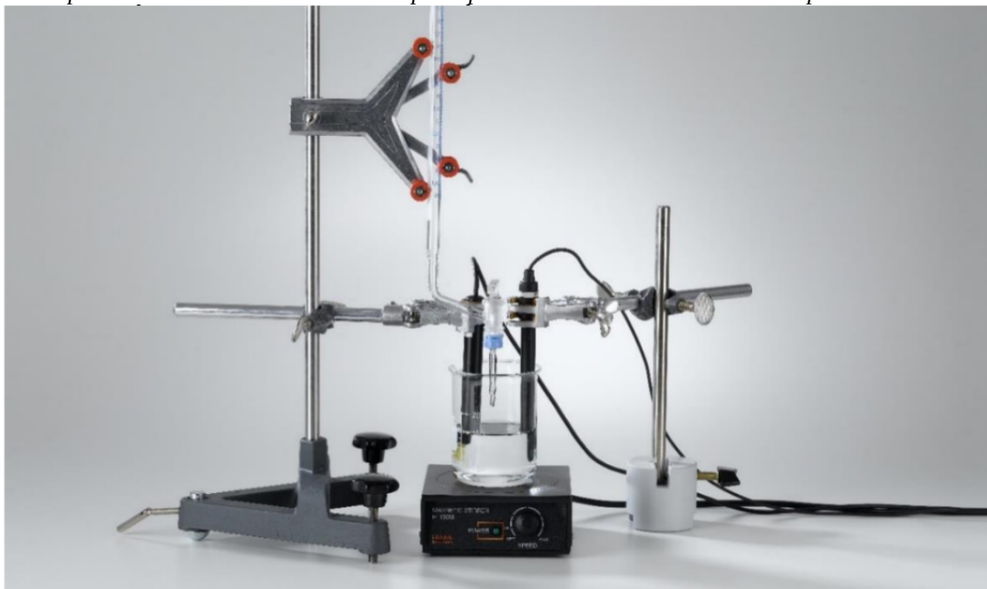
Рис.1: Экспериментальная установка для кондуктометрического титрования с измерением рН.
