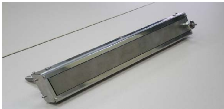
Рисунок 1 – Линейный, протяженный электродуговой испаритель
