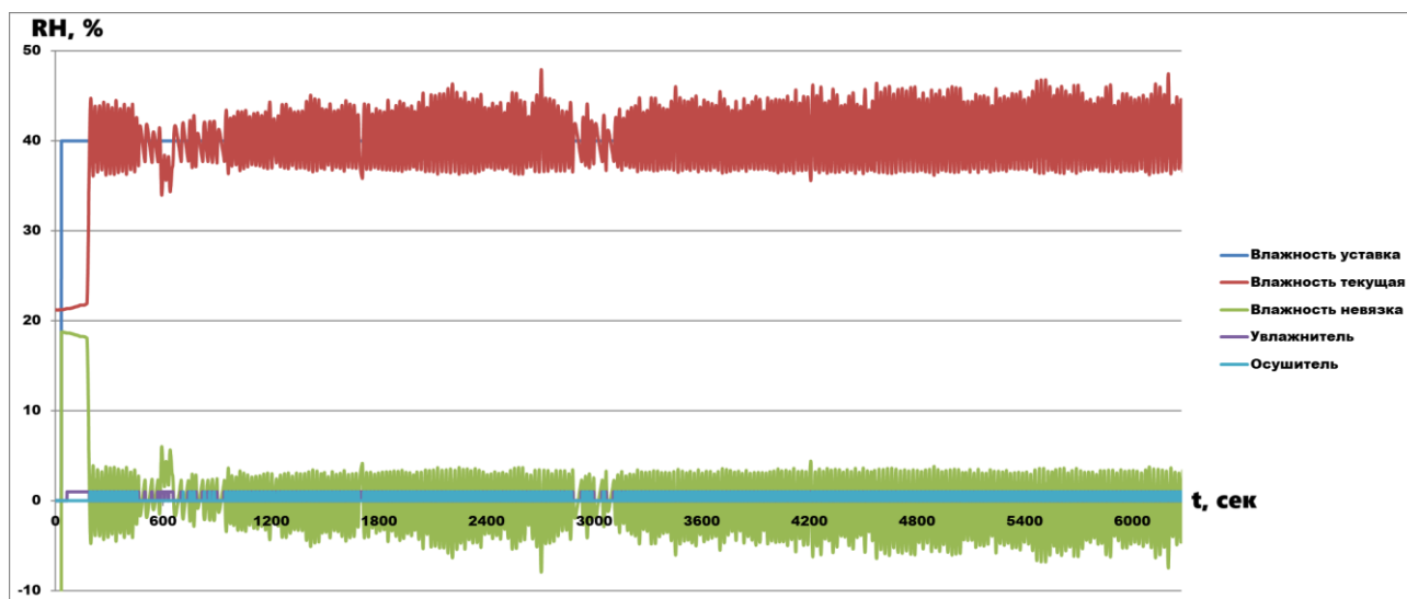
Рис.2. График процесса сушки (влажность) при релейном регулировании
