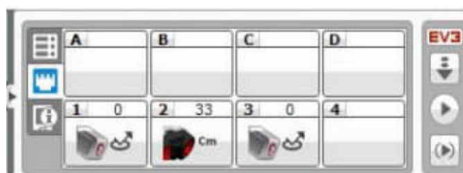
Рис. 6. Значение с ультразвукового датчика при эксперименте с закругленной поверхностью
