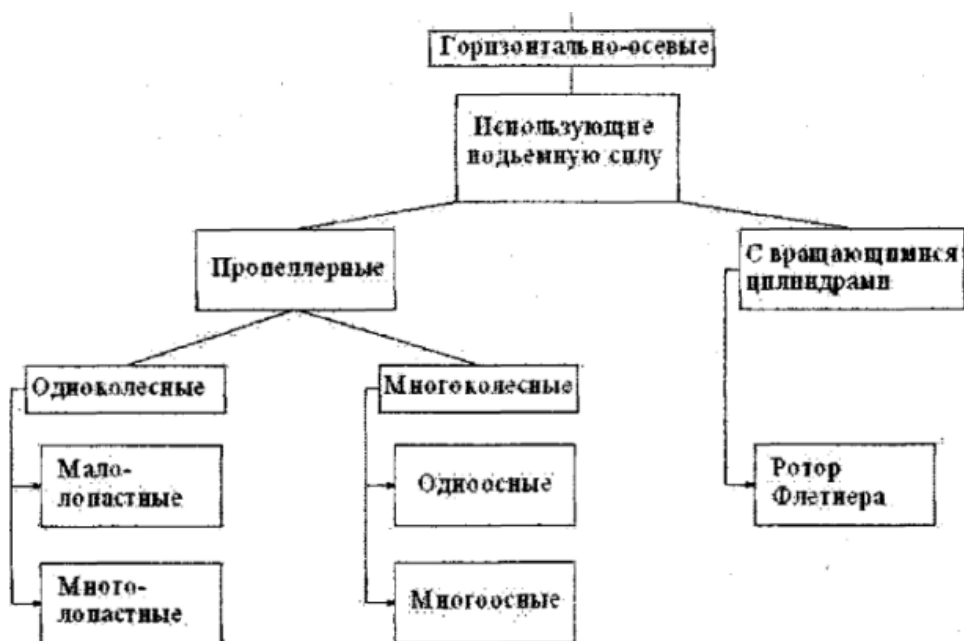
Рисунок 1 - Классификация коллинеарных ветродвигателей (ветротурбин) с механической передачей
