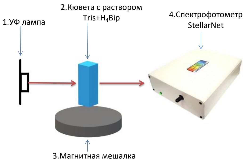
Рисунок 9 - Схема экспериментальной установки регистрации спектров поглощения раствора птеринов, состоящая из: 1 – УФ лампа; 2 – Кювета с раствором Tris+H 4 Vip; 3 – магнитная мешалка; 4 – Спектрофотометр StellarNet.
