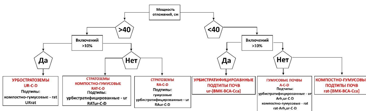
Рисунок. Блок-схема классификации антропогенных почв (в условиях г. Волгограда)
