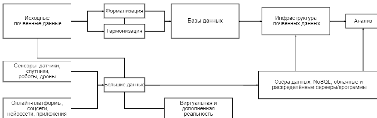
Рисунок 1. Блок-схема получения, обработки и анализа почвенных данных
