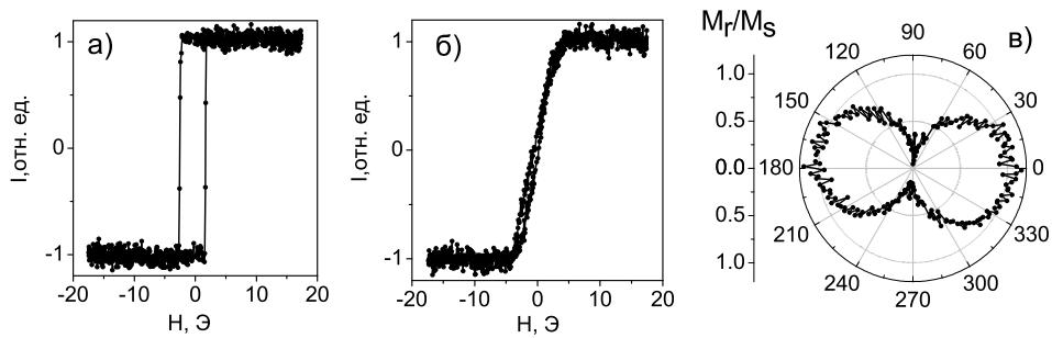
Рис. 2. Кривые намагничивания, полученные на магнитополяриметре: а) в направлении ОЛН, б) в направлении оси трудного намагничивания; и азимутальная зависимость приведённой остаточной намагниченности  $M_r/M_s$  (в)
