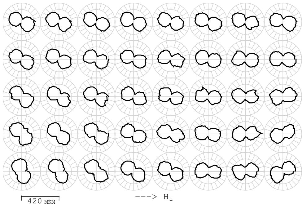
Рис. 3. Топограмма азимутальных зависимостей приведённой остаточной намагниченности для образца кремния, имплантированного ионами  $\text{Fe}^+$  во внешнем магнитном поле  $H_i = 200 \text{ Г}$
