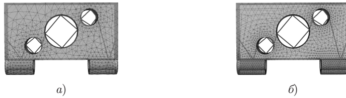
Рис. 7. Граф Рибо на сетках с различным числом ячеек: а) грубая сетка – 12351; б) вложенная сетка – 60017
