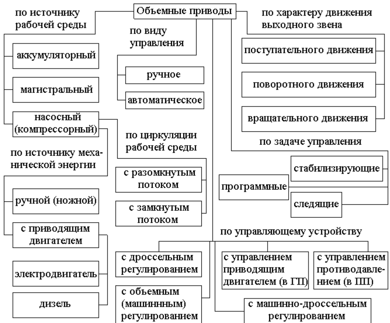
Рисунок 4.2.2 – Классификация объемных гидро- и пневмоприводов
