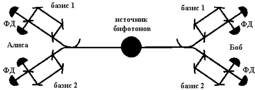
Рис. 3. Схема, реализующая кодирование по фазе и времени со вторым набором интерферометров
