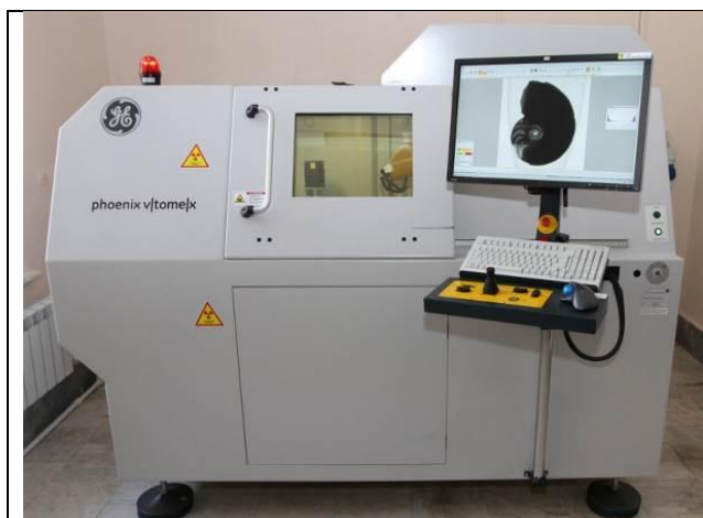
Микро и нанофокусная исследовательская рентгеновская система для компьютерной томографии V|tome|X S 240 (Германия)
