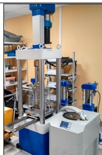
Автоматизированная установка для комплексных испытаний горных пород при нормальных и повышенных термобарических параметрах, моделирующих пластовые условия.
