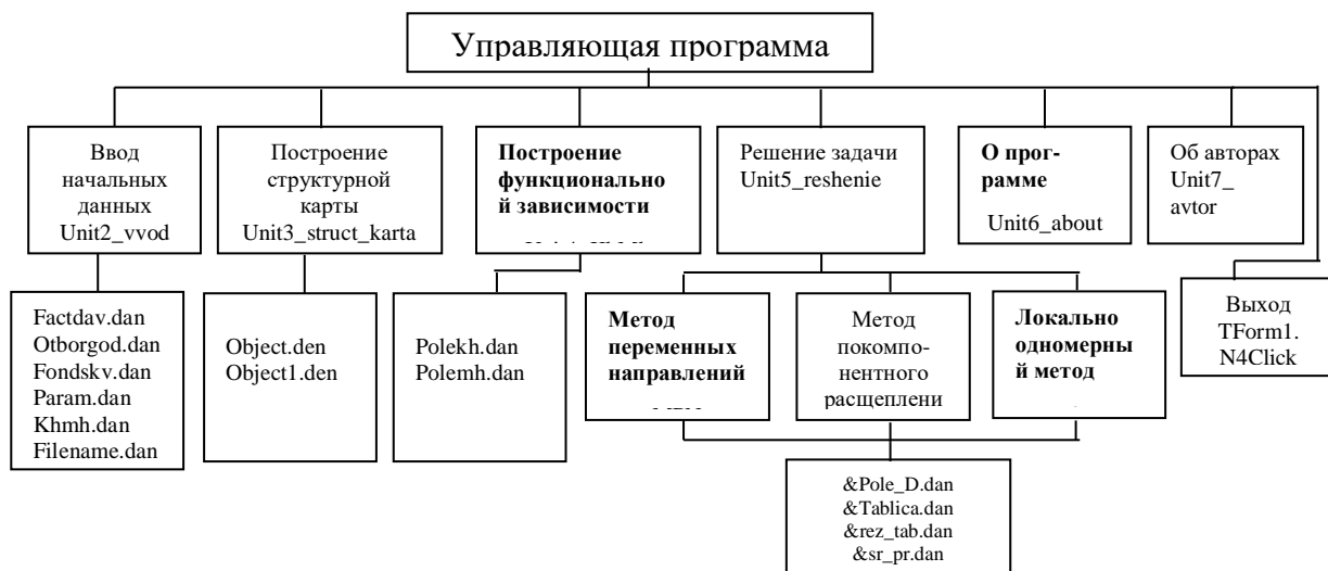
Рис.4. Структура программного обеспечения оптимального управления фильтрацией газа
