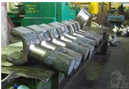
Рис. 86. Типовые отливки, получаемые электрошлаковым литьём.
