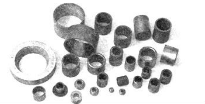
Рис.177. Антифрикционные пористые металлокерамические изделия
