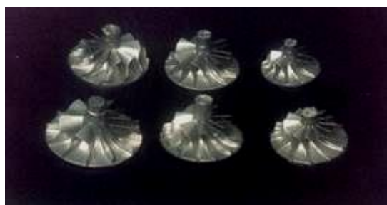
Рис.69.Типовые тонкостенные отливки крыльчаток, изготовленные вакуумным всасыванием
