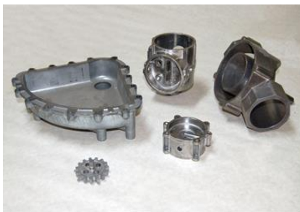
Рис.99. Типовые заготовки, изготовленные литьём под давлением.
