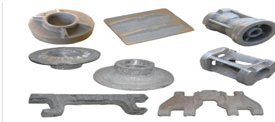
Рис.15. Типовые литые заготовки в песчано – глинистые формы.
