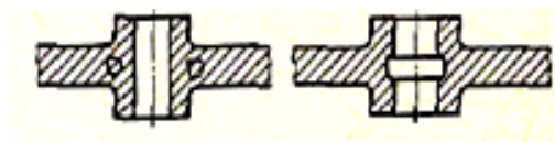
Рис.5. Проектирование втулки с фланцем а- неправильно б- правильно
