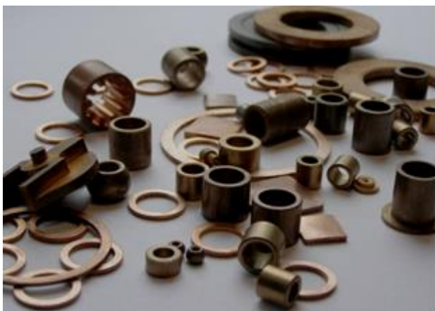
Рис. 176. Типовые детали, изготовленные методом порошковой металлургии
