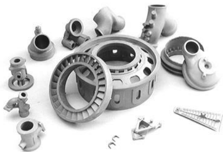
Рис. 26 Типовые отливки литья по выплавляемым моделям различных вариантов
