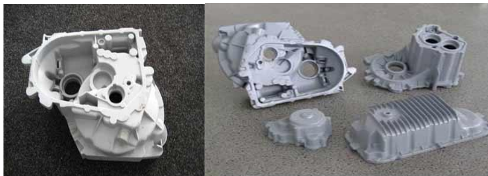
Рис.61. Типовые отливки литья под низким давлением
