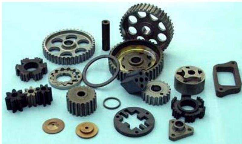
Рис.180. Различные металлокерамические изделия с высокой чистотой поверхности
