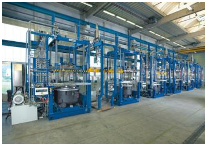
Рис.63. Производственный цех литья заготовок под низким давлением
