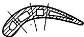
Рис. 34. Пример оформление штырьков и галтелей относительно спинки и корыта
