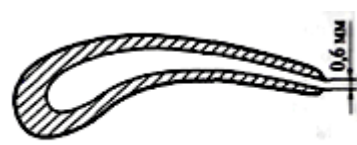
Рис.35 Предельный размер щели по выходной кромке пера
