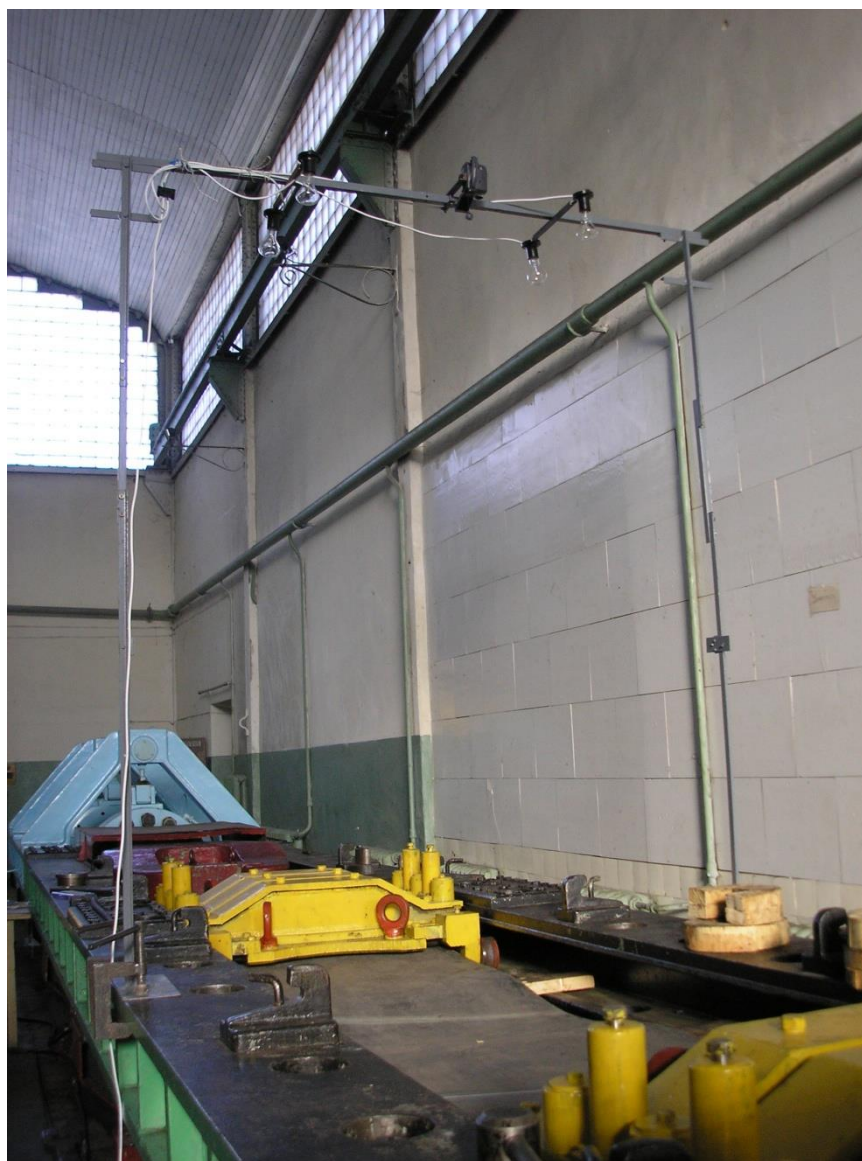
Рис. 1. Общий вид стенда для испытаний на разрыв стыков конвейерной ленты
