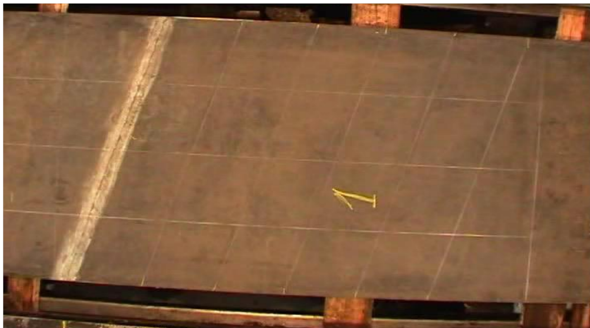
Рис. 2. Пример нанесения координатной сетки на испытываемый стык конвейерной ленты
