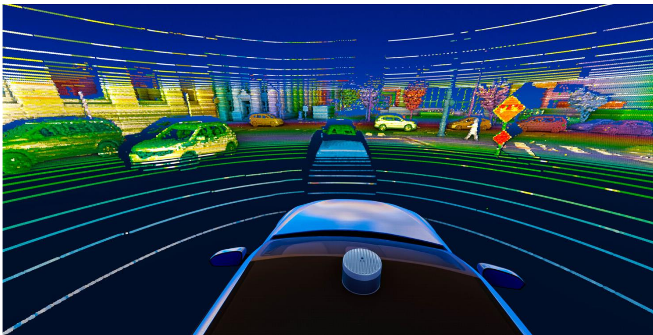
Рис. 3 Карта, построенная при помощи LiDAR Velodyne Puck LITE
