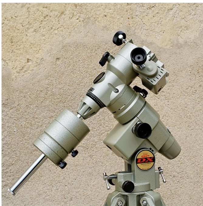
Рисунок 1.2.2 - Экваториальная монтировка немецкого типа для любительского телескопа.
