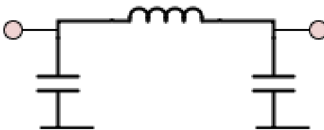
Рисунок 11. Эквивалент длинной линии - цепь с сосредоточенными параметрами, LC-контур.
