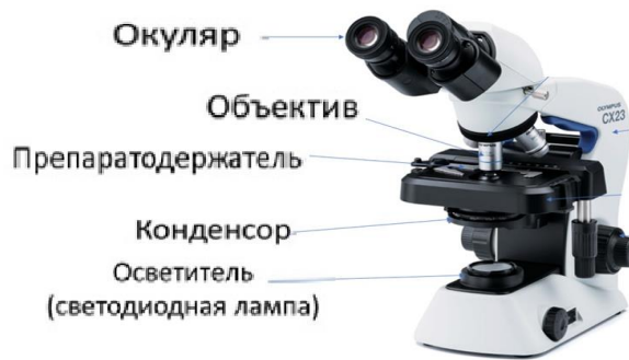
Рисунок 19 – Основные элементы простейшего светового микроскопа
