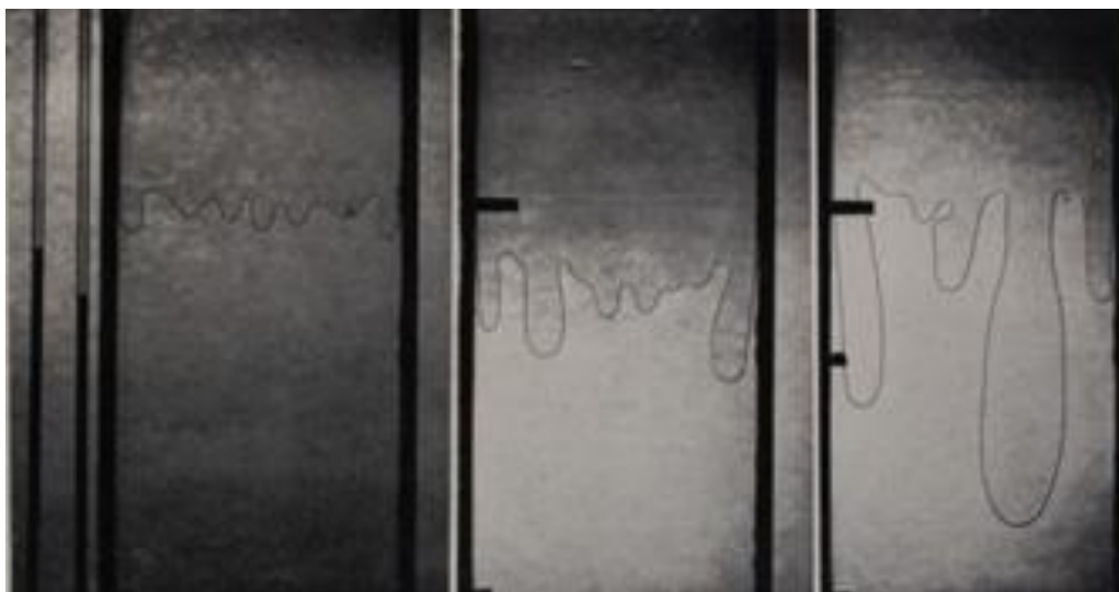
Рис.1.1 Воздух, подаваемый под давлением, вытесняет глицерин в вертикальной ячейке Хеле–Шоу; средняя скорость двух сред, направленная к низу, составляет порядка 1 мм/с.
