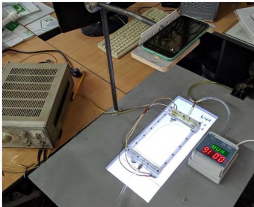
Рис. 3.2 – Модернизированная экспериментальная установка с LED подсветкой и излучателями колебаний
