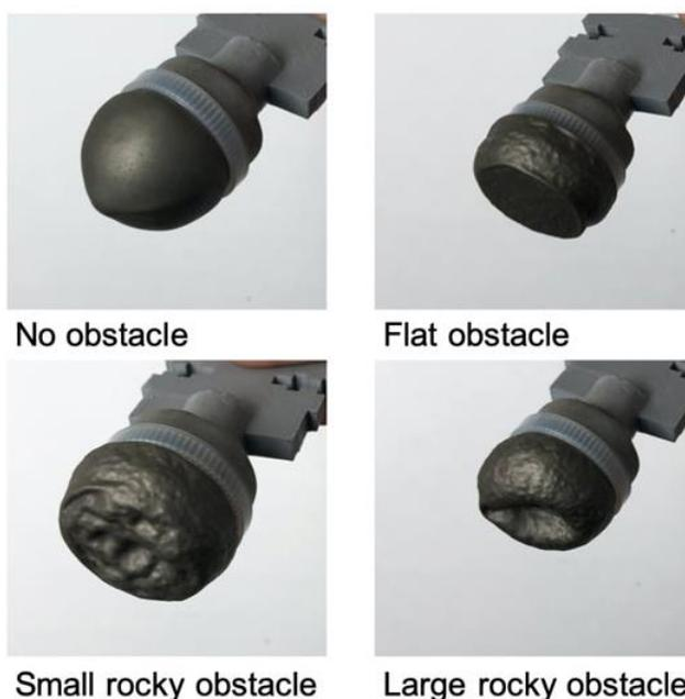
*Мягкая робонога адаптируется под тип поверхности, на который она ступает, что позволяет роботу ходить быстрее. Изображение: UC San Diego*
