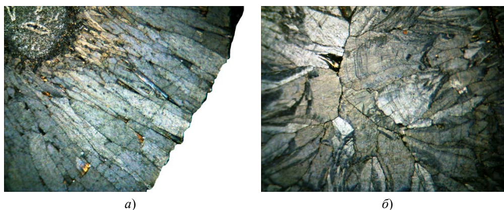
Рис. 3. Фото участков пиритовых конкреций с зонами локализации углеродистого вещества, к которым приурочены агрегаты самородного железа: а – периферия конкреции с темными включениями углеродистого вещества; б – темное углеродистое вещество, защемленное между крупными зернами пирита
