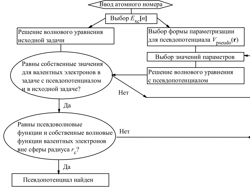
Рис. 3. Блок-схема, описывающая процедуру подбора эффективных параметров псевдопотенциала
