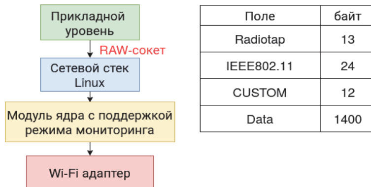
Рис. 1. Передача данных от прикладного уровня в Wi-Fi адаптер в режиме мониторинга и формат пакета
