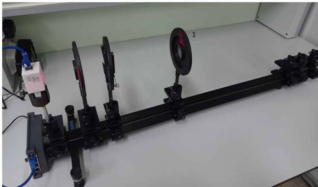
Рис.4 Оптическая схема для определения расстояния между когерентными источниками.
