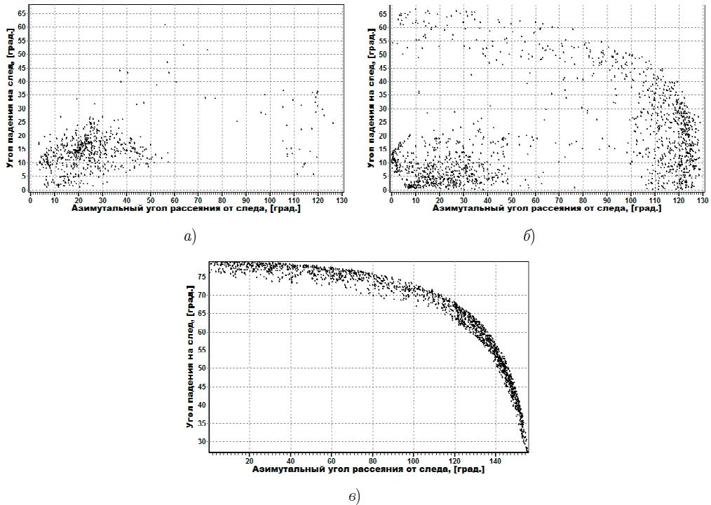
Рис. 6. Диаграммы совместного распределения угла падения и угла рассеяния радиоволны: а) для типичных следов при  $L = 475$  км; б) для невзаимных следов при  $L = 475$  км; в) для типичных следов при  $L = 1200$  км
