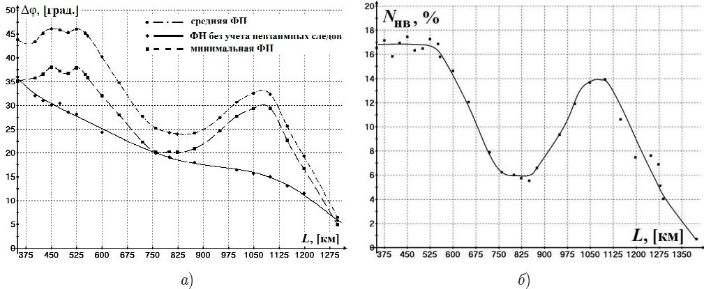
Рис. 3. *a*) ФН для радиолиний различной длины; *б*) доля невзаимных следов
