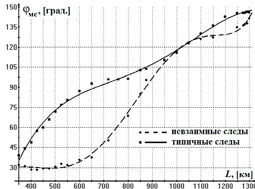
Рис. 5. Азимутальный угол рассеяния для радиолиний различной длины
