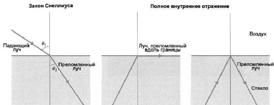
Рис. 1. Преломление и отражение лучей от границы раздела двух сред в соответствии с законом Снеллиуса
