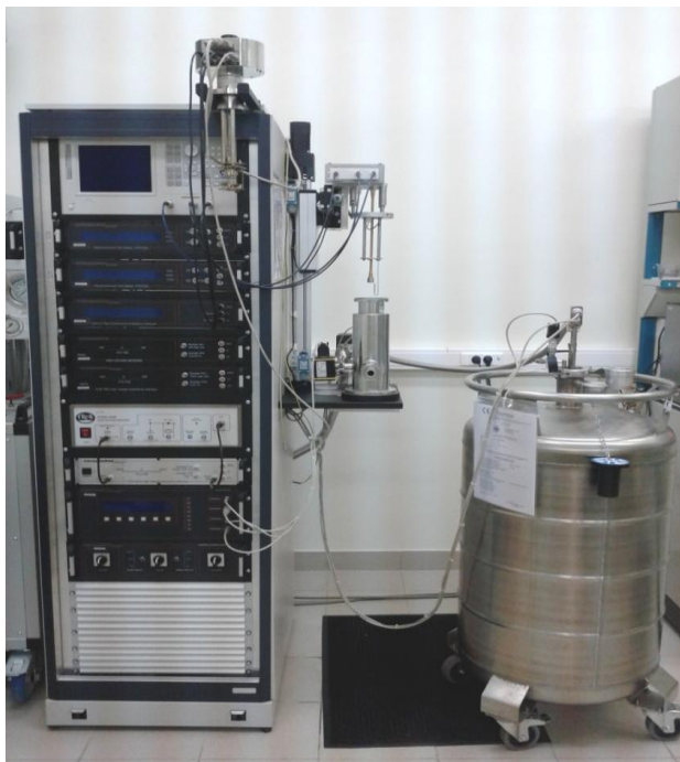
Рис. 3.1 Измерительный комплекс NOVOCONTROL BDS CONCEPT 80
