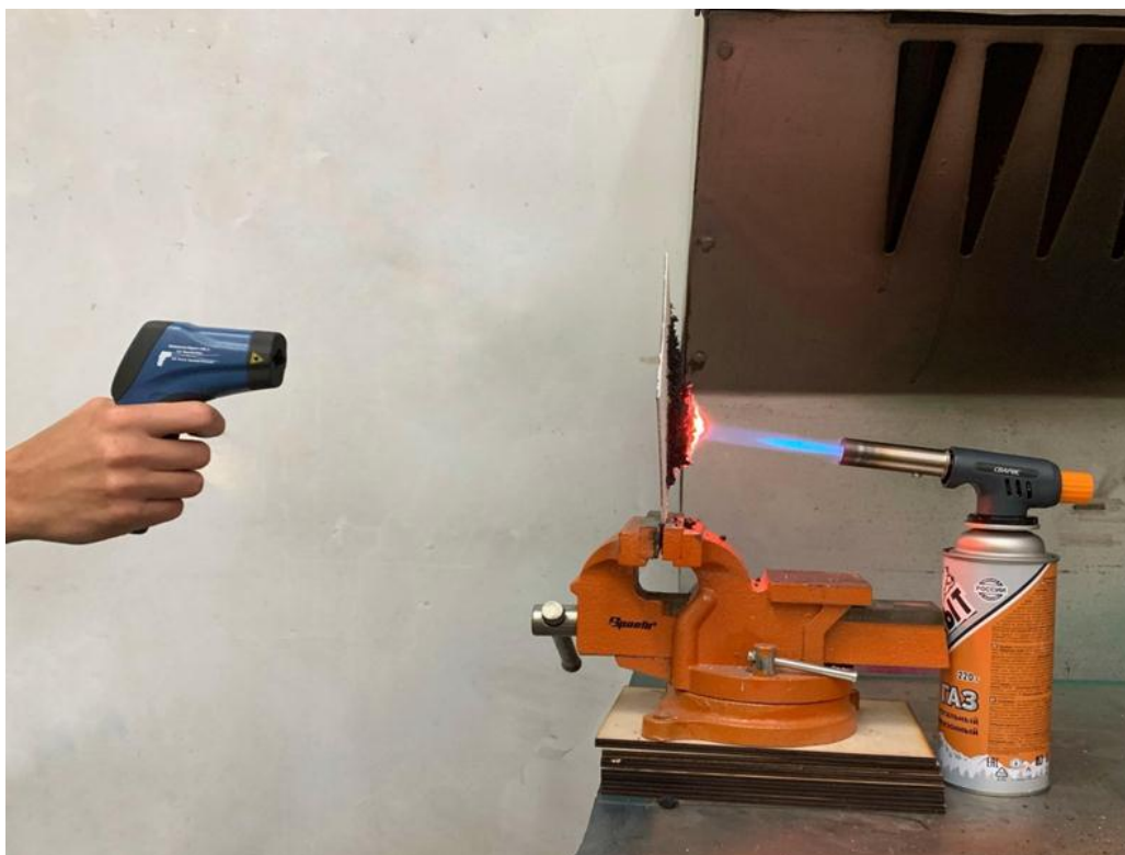
Рис. 1. Проведение замеров температуры образцов подвергнутых воздействию открытого пламени
