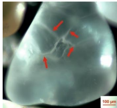
Рис. 6. Внутренние деформации флюидного включения. Проба Kuch-1, фракция 0.63–1.25 мм. Стрелками показаны трещины вокруг включения, совпадающие с направлением сдавливания зерна
