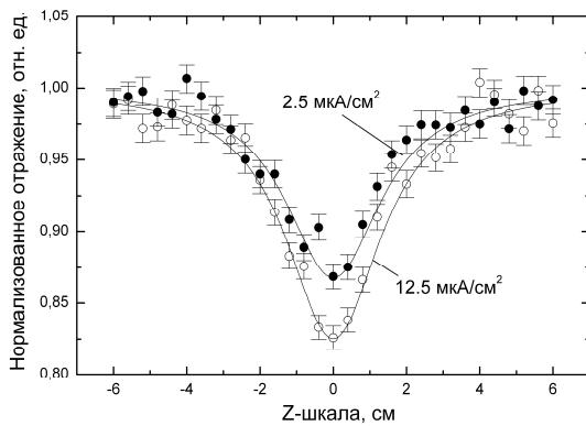
Рис. 3. Зависимость нормализованного отражения для образцов Cu:Al<sub>2</sub>O<sub>3</sub>, синтезированных ионной имплантацией с различными значениями плотности тока в ионном пучке. Сплошными линиями показаны расчетные кривые. Интенсивность лазерного излучения составляла 7,7 · 10<sup>9</sup> Вт/см<sup>2</sup>
