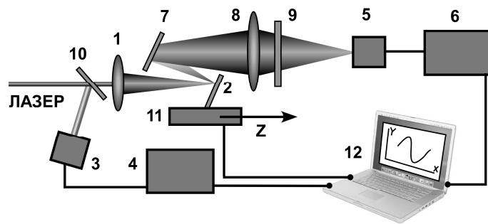
Рис. 1. Схема экспериментальной установки по  $z$ -сканированию при отражении: 1 и 8 – фокусирующие линзы; 2 – образец; 3 и 5 – фотодиоды; 4 и 6 – цифровые вольтметры; 7 – поворотное зеркало; 9 – нейтральный фильтр; 10 – оптический делитель; 11 – микрометрический стол, 12 – компьютер
