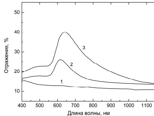
Рис. 2. Спектры отражения необлученного (1) и имплантированного  $\text{Al}_2\text{O}_3$  ионами меди с энергией 40 кэВ, дозой  $10^{17}$  и различными значениями ионного тока:  $2.5 \text{ мкA}/\text{см}^2$  (2) и  $12.5 \text{ мкA}/\text{см}^2$  (3)
