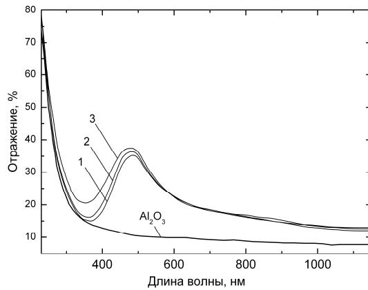
Рис. 4. Спектры отражения необлученного и имплантированного  $\text{Al}_2\text{O}_3$  ионами серебра с энергией 30 кэВ, дозой  $3.75 \cdot 10^{17}$  ион/ $\text{cm}^2$  и различными значениями плотности тока в ионном пучке: 3 мК $\text{A}/\text{cm}^2$  (1); 6 мК $\text{A}/\text{cm}^2$  (2) и 10 мК $\text{A}/\text{cm}^2$  (3)
