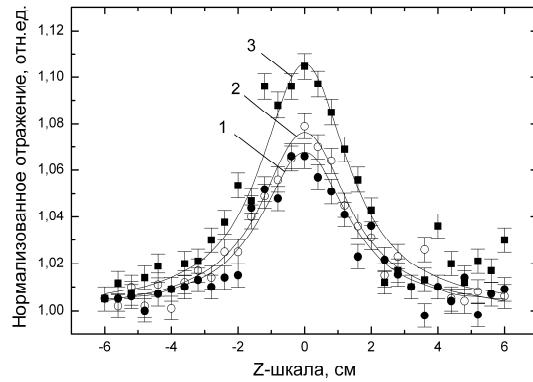
Рис. 5. Зависимость нормализованного отражения  $\text{Ag}:\text{Al}_2\text{O}_3$  с наночастицами серебра, синтезированными ионной имплантацией с различными значениями плотности тока в ионном пучке: 3 мК $\text{A}/\text{cm}^2$  (1); 6 мК $\text{A}/\text{cm}^2$  (2); 10 мК $\text{A}/\text{cm}^2$  (1). Сплошными линиями показаны расчетные кривые. Интенсивность лазерного излучения  $4.3 \cdot 10^9$  Вт/ $\text{cm}^2$
