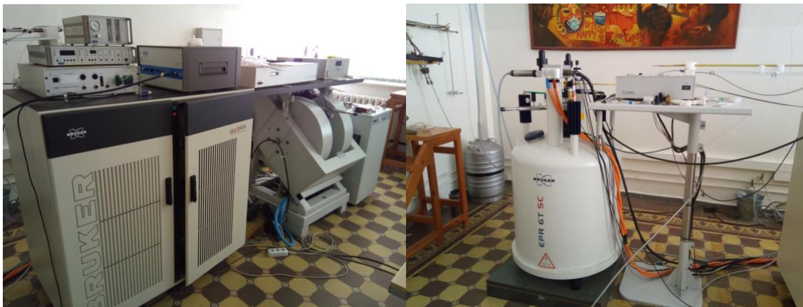
Рисунок 4 - ЭПР спектрометр фирмы Bruker серии Eleksys а) E580 X-диапазон \nu = 9.6 ГГц, б) E680 W-диапазон \nu = 94 ГГц
