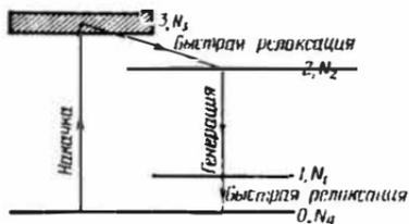
Рис. 5.1. Схема энергетических уровней четырехуровневого лазера.
