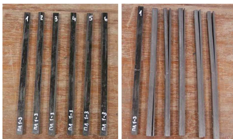
Рис. 13. Длинные образцы до и после испытаний на трёхточечный изгиб в плоскости 1–3
