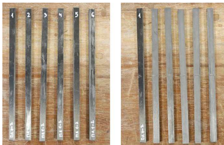
Рис. 9. Длинные образцы до и после испытаний на трёхточечный изгиб в плоскости 1–2
