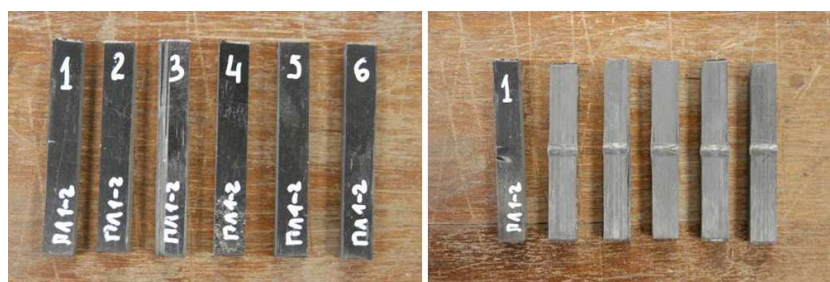
Рис. 11. Короткие образцы до и после испытаний на трёхточечный изгиб в плоскости 1–2
