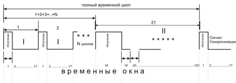
Рис. 1. Алгоритм работы блока управления генератором
