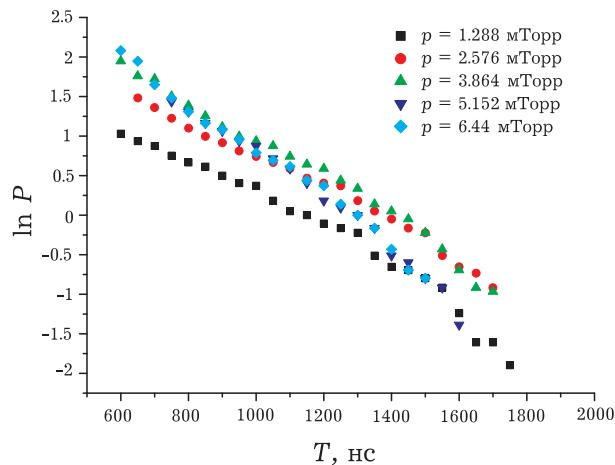
Рис. 1. Затухание фотонного эха при разных задержках электрических импульсов и разных давлениях газа  $^{13}\text{CH}_3\text{F}$
