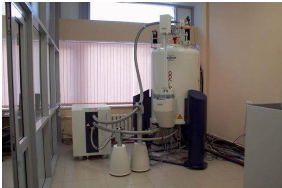
Рисунок 16 – Спектрометр "AVANCE III - 700" – спектрометр со сверхпроводящим магнитом
