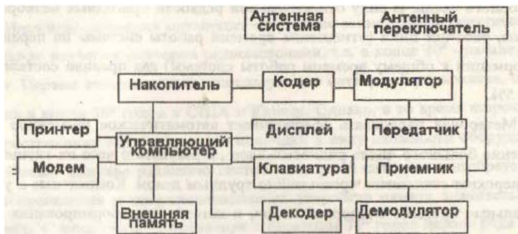
Рисунок 5 - Блок-схема метеорной радиосистемы
