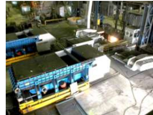
Печной комплекс ф. «Отто Юнкер» Производительность 29,7 тонн/час
