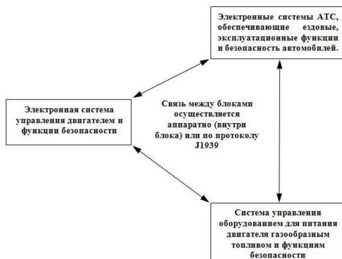
Рисунок 1. Схема распределения функции электронных систем автотранспортных средств, укомплектованных двигателем с принудительным зажиганием и оборудованием для питания двигателя газообразным топливом
