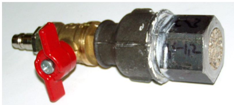
Рис. 1.5. Узел стыковки пористого образца с компрессором.
