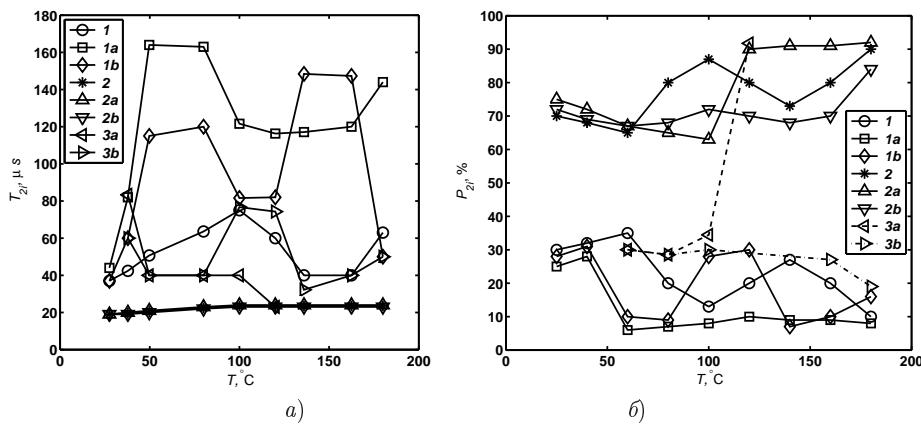
Рис. 1. Температурная зависимость времен  $T_{2i}$  (а) и соответствующих им населенностей  $P_{2i}$  (б) поперечной ядерной магнитной релаксации контрольного (1, 2) и обработанных в гидрофильтром (1а, 2а, 3а) и гидрофобном (1б, 2б, 3б) режимах образцов войлока: 1, 1а, 1б – параметры более подвижной (первой) фазы ( $T_{21}, P_{21}$ ), 2, 2а, 2б – параметры менее подвижной (второй) фазы ( $T_{22}, P_{22}$ ), 3а, 3б – параметры промежуточной или пограничной (третьей) фазы ( $T_{2n}, P_{2n}$ )
