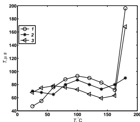
Рис. 2. Температурная зависимость времен  $T_1$  продольной ядерной магнитной релаксации контрольного (1) и обработанных в гидрофильном (2) и гидрофобном (3) режимах образцов волокна
