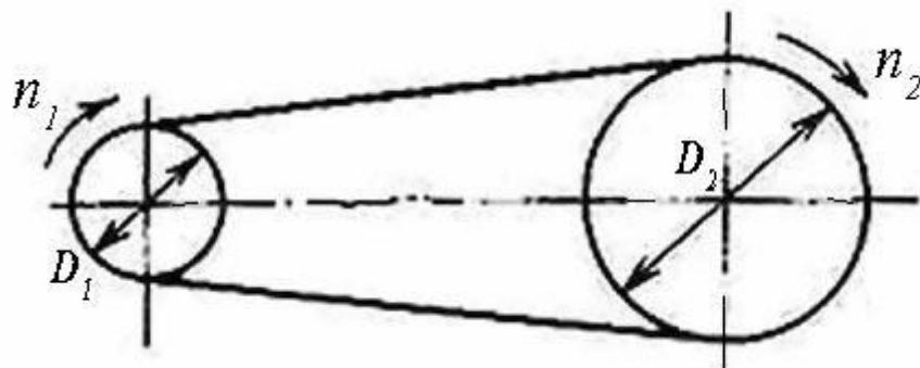
**20.** Определите количество зубьев  $Z_1$  на ведущей шестерне изображенной здесь передачи, если известно, что передаточное число передачи  $u = 3,0$ , диаметр ведомого колеса  $D_2 = 240$  мм, модуль зубьев  $m = 4$  мм. (OK-1, OK-2; OK-3;OK-4, OK-8, OK-9, ПК-1.1, ПК-1.3, ПК-4.1, ПК-4.4)
