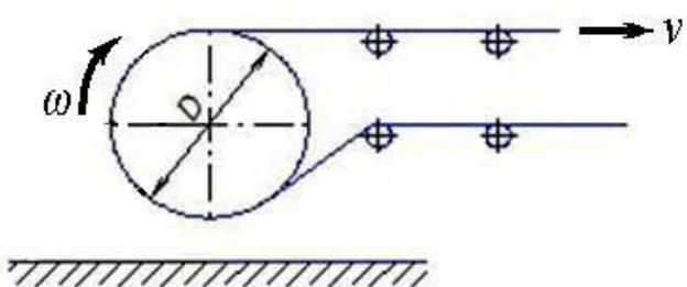
**18.** Определите мощность  $P_1$  и крутящий момент  $T_1$  на ведущем валу изображенной на схеме передачи, если известно, что  $\omega_1 = 10\pi$  рад/сек,  $\omega_2 = 4\pi$  рад/сек, вращающий момент на ведомом валу  $T_2 = 100$  Нм, КПД передачи  $\eta = 0,94$ . (OK-1, OK-2; OK-3;OK-4, OK-8, OK-9, ПК-1.1, ПК-1.3, ПК-4.1, ПК-4.4)
