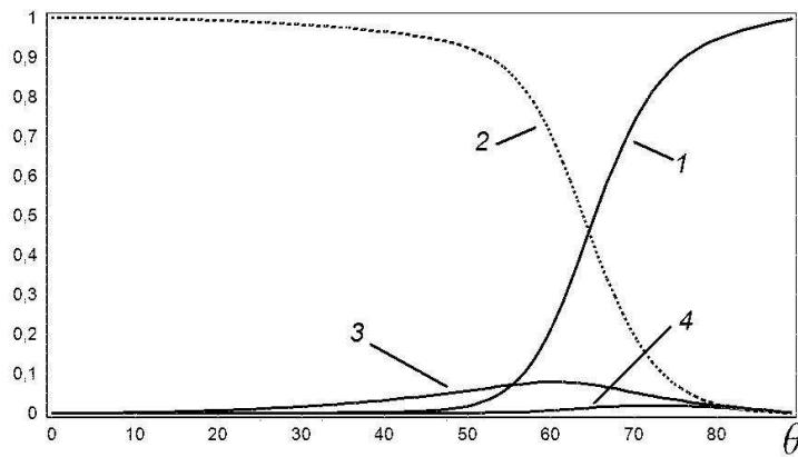
Рис. 3. Зависимость прошедшей и отраженной энергии от угла падения  $\theta$  волны вида (16) на градиентный слой толщины  $L = 10$  м при частоте  $\omega = 2 \cdot 10^3$ . Параметры совпадают с параметрами рис. 2. Первый график соответствует энергии отраженной продольной волны, 2 – прошедшей продольной, 3 – отраженной поперечной, 4 – прошедшей поперечной
