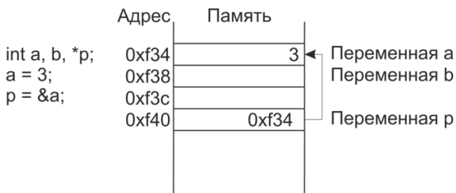
Рис. 5.1. Пример объявления и использования переменной-указателя ( p )
