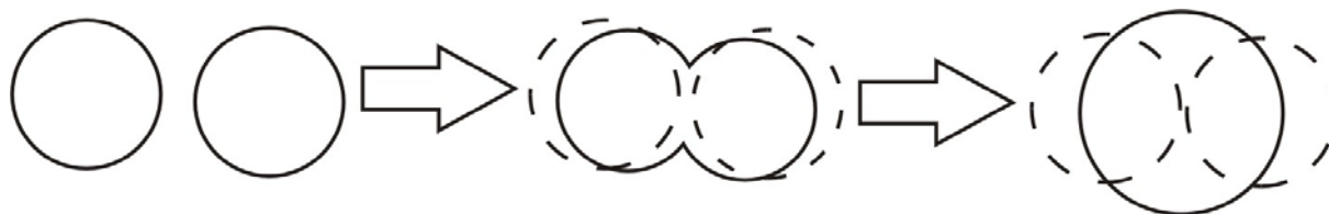
Рис.5. Схема изменения формы сферических островков в процессе коалесценции
