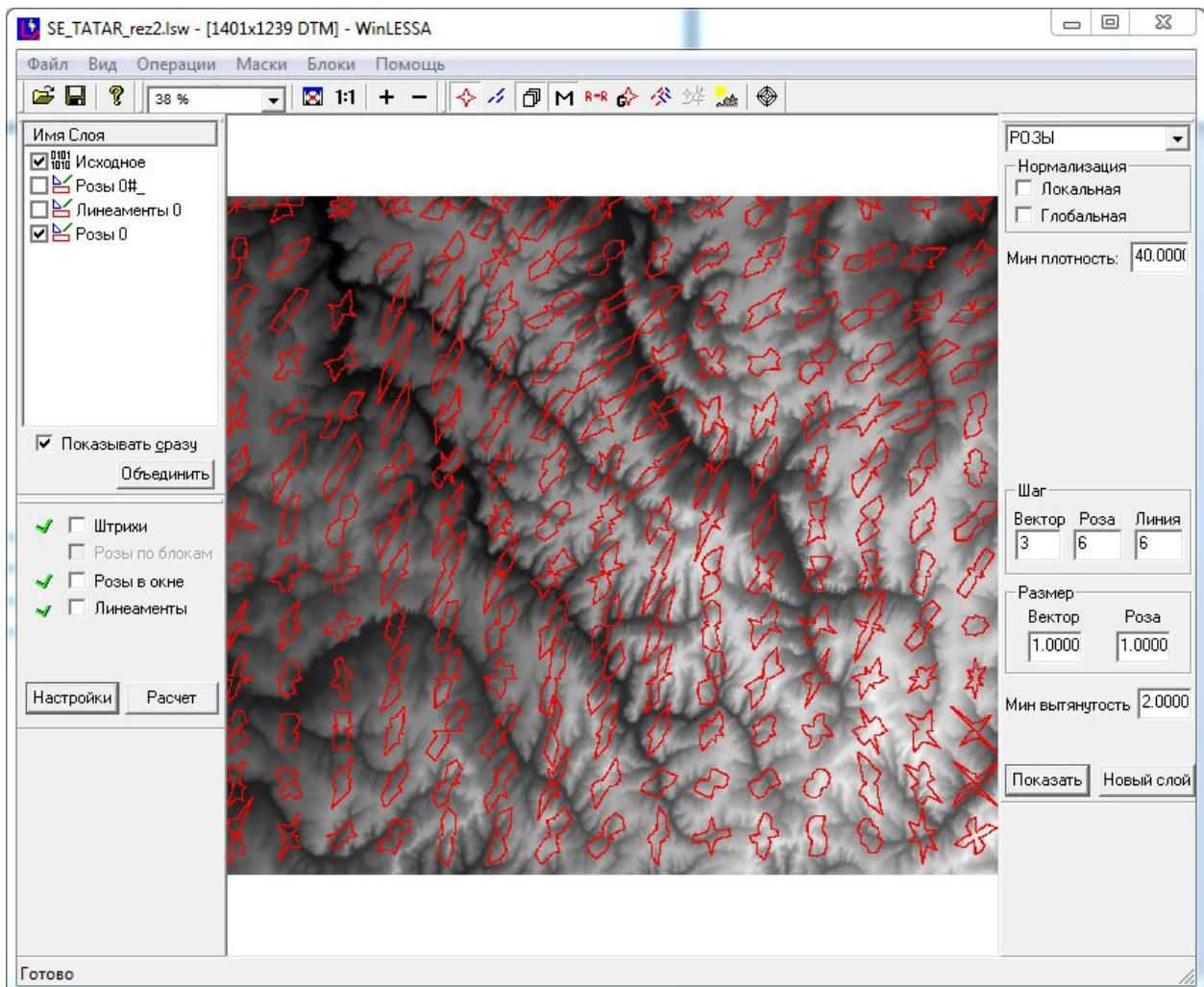
Рисунок 5 – Графическое представление расчета роз-диаграмм в окне
