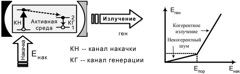
Испускание когерентного излучения можно описывать как критический переход, вызванный внешним параметром —  $E_{нак}$ . При  $E_{нак} > E_{пор}$  внутреннее электромагнитное поле вызывает коррелированные акты вынужденного испускания в противовес случайному характеру спонтанного излучения.
