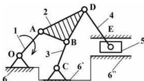
Назначение механизма: преобразовать вращательное движение кривошипа в поступательное движение ползуна с усложненным законом движения.
