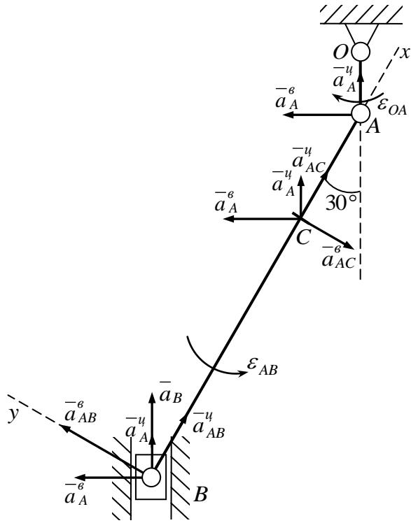
Эти ускорения определим из уравнений проекций векторного равенства (1) на оси координат. Знак в ответе показывает, соответствует ли истинное направление вектора принятому при расчёте.
